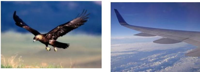
**Abb. 8/9:** Links: Adler im Gleitflug mit gespreizten Flügelspitzen. Rechts: Flügel eines großen Passagierflugzeugs mit Winglet.
