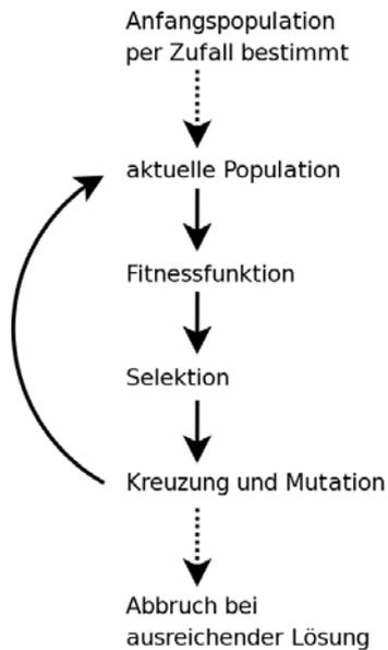
**Abb. 2:** *Durchführungsabfolge eines Evolutionären Algorithmus*
